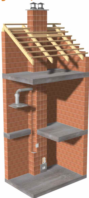
Využití ventilačního průduchu (připojení digestoře)
