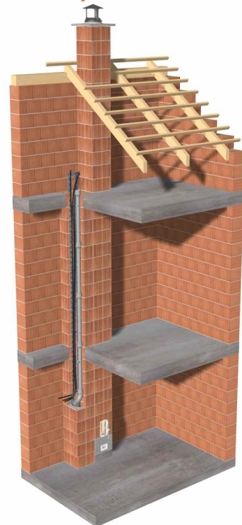
Využití ventilačního průduchu (uložení rozvodů)
